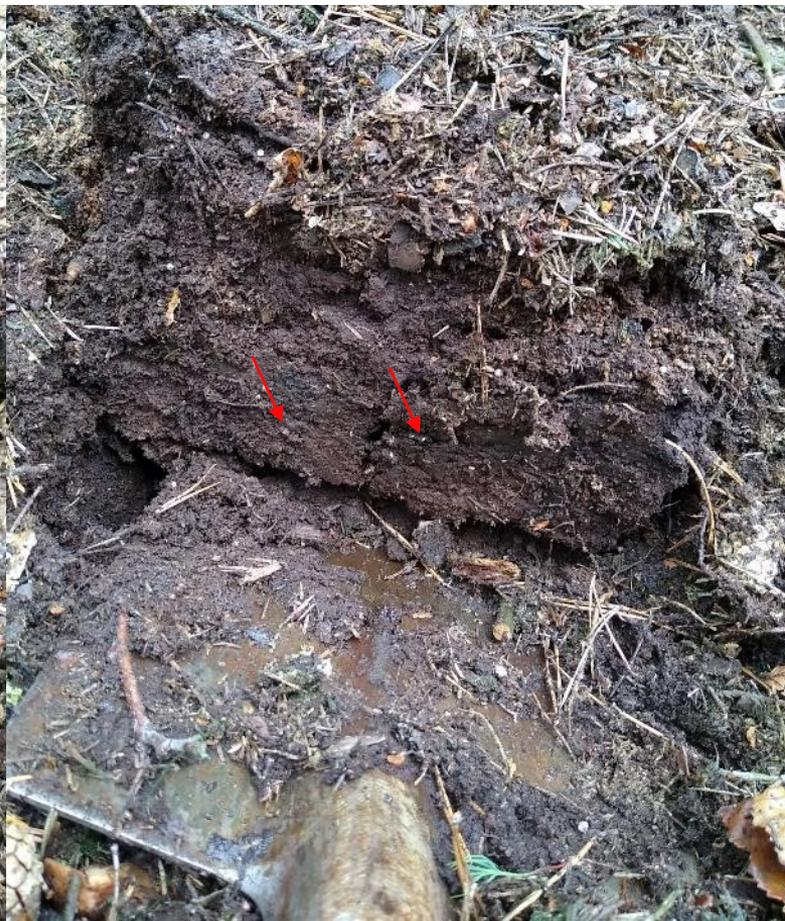
Foto links: Schurf im Teilfeld 4 (SB 20/04) des Sanierungsbereichs. Sandige Auffüllungen mit vielen Bauschuttresten (Rotstein und Beton) mit Stauwasser (SB 20/04-W1; 14. Juli 2018).
